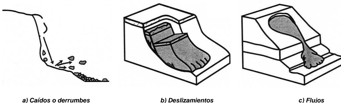
Figura 5.1 Principales tipos de deslizamientos en laderas
