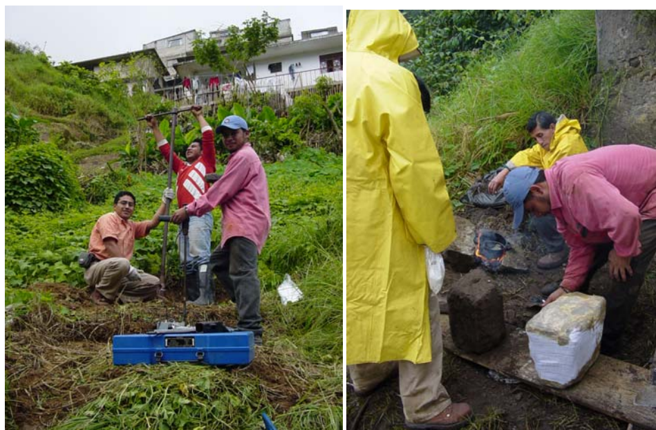
Figura 5.28 Recuperación de muestras de suelo alteradas e inalteradas en dos laderas de la Colonia B. Juárez
